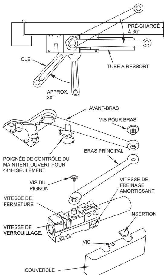
1. Déterminez le main de la porte (voir ci-dessus) et positionnez le ferme-porte avec l'extrémité du tube à ressort située loin de l'axe des charnières.
